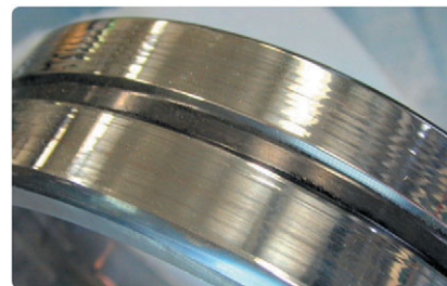
Rys. 2. Zużycie przez polerowanie powierzchni spowodowane pełzaniem pierścienia zewnętrznego; klasyfikacja ISO: zużycie ściernie
