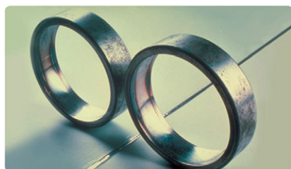
Rys. 11. Pierścień zewnętrzny tego łożyska kulkowego wahliwego jest umieszczony naprzeciwko lustra, można zauważyć dwie strefy obciążenia i łuszczenie oddalone o 180°, uszkodzenie było skutkiem nieokrągłego gniazda oprawy; klasyfikacja ISO: zmęczenie materiału zapoczątkowane pod powierzchnią
