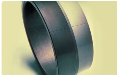
Rys. 4. Pęknięcie pierścienia spowodowane nadmiernym wciskiem; klasyfikacja ISO: pęknięcie wymuszone
