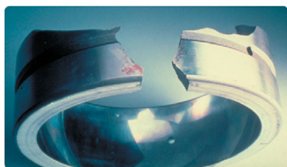
Rys. 10. Pierścień zewnętrzny tego łożyska nie był prawidłowo podparty w gnieździe oprawy, korozja cierna doprowadziła do wysokich naprężeń w pierścieniu zewnętrznym i ostatecznie jej rezultatem było pęknięcie wymuszone pierścienia; klasyfikacja ISO: korozja cierna i pęknięcie wymuszone
