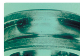
Etap 2: Następuje rozwój mikropęknięć powierzchniowych. Następnie pojawiają się mikrołuszczenia.
