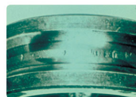
Etap 3: Po oderwanych od powierzchni cząstkach materiału przetaczają się elementy toczne i pojawia się prawdziwe łuszczenie.
