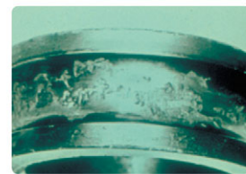
Etap 4: Jeśli łożysko pracuje w tym stanie zbyt długo, łuszczenie występuje na całej bieżni; nie można już zauważyć uszkodzenia pierwotnego.
