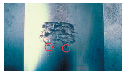
Rys. 4. Łuszczenie w łożysku kulkowym zwykłym spowodowane wgnieceniami; klasyfikacja ISO: wgniecenie cząstek zanieczyszczeń
