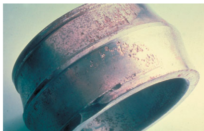
Rys. 2. Zaawansowane zużycie na nieruchomym pierścieniu wewnętrznym łożyska barytkowego; klasyfikacja ISO: zużycie ścierne
