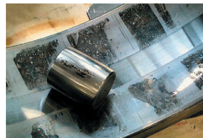
Rys. 5. Kwas wytworzony przez wilgoć w łożysku barytkowym; klasyfikacja ISO: korozja od wilgoci
