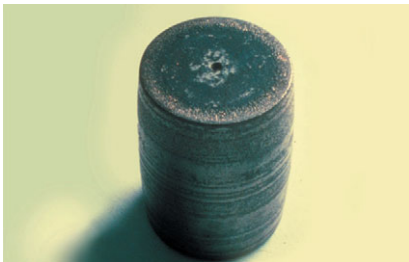
Rys. 7. Rdza na elemencie tocznym łożyska baryłkowego spowodowana wilgocią podczas długiego postoju; klasyfikacja ISO: korozja od wilgoci
