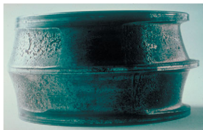
Rys. 3. Bardzo zaawansowane zużycie na nieruchomym pierścieniu wewnętrznym dużego łożyska barytkowego; klasyfikacja ISO: zużycie ścierne
