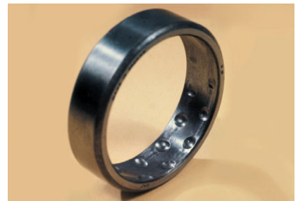
Rys. 8. Uszkodzenie spowodowane drganiami w łożysku kulkowym wahliwym w urządzeniu pozostającym w stanie spoczynku; klasyfikacja ISO: fałszywe odciski Brinella
